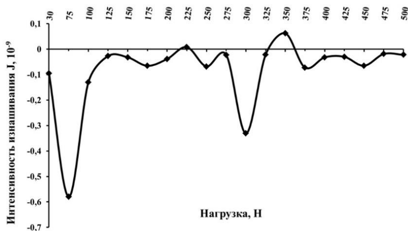
Рисунок 1. - Зависимость интенсивности изнашивания от нагрузки на образец: а - сталь 40Х с покрытием; б - контртело сталь ШХ15
