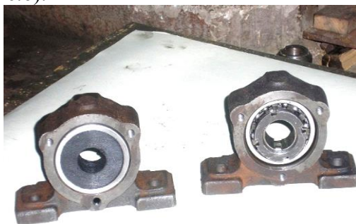
Рисунок 5. – Подшипниковые узлы подшипника скольжения из АДПКМ -1 на основе тополя (а) и подшипника качения (б)
